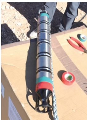
写真左 水中録音機器。長さ53 cm、直径6 cmの機器(大槻真友子撮影)
