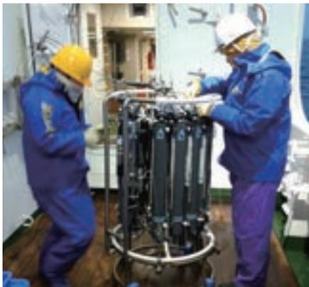
写真1 最新装備の例、有線式CTDとニスキン採水器
