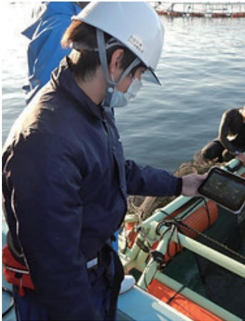
養殖生簀で、魚体長計測カメラを用いて魚を計測している様子
