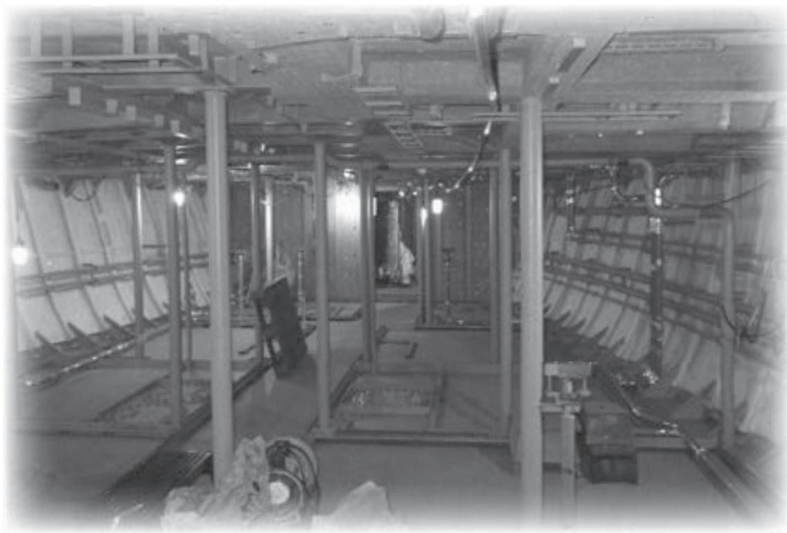
写真1 防熱工事施工後の船倉甲板居住区
