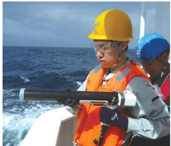
写真2. XCTD(投下式塩分水温深度計)発射に身構える男子学生
