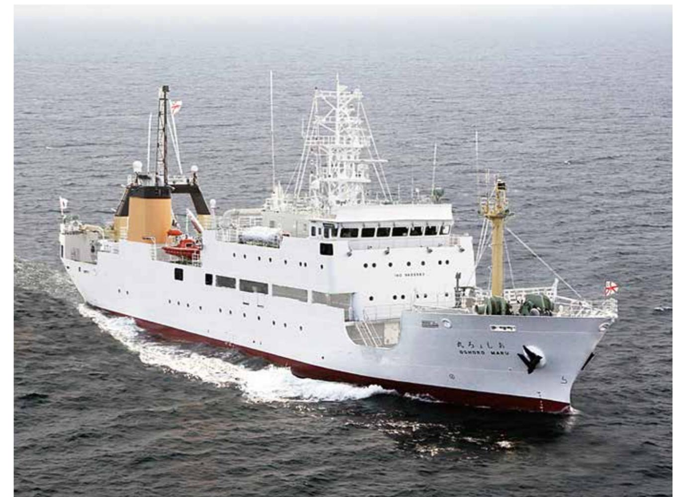
おしょろ丸V世の概要を簡単に説明する。おしょろ丸V世は、全長78.27m、幅(型)13.00m、深さ(型)5.80m、計画満載喫水(型)5.00mのウエル甲板船で、国内総トン数 1,598トン(国際総トン数 1,998トン)である。おしょろ丸V世の一般配置図を図1に示す。船首尾楼間の特徴的くぼみ(凹)がウエル甲板で、従来のおしょろ丸(Ⅲ世、Ⅳ世)の流れをくむ観測や実習の利便性にこだわった形状である。船尾にスリップウェイを設けた船尾トロール型の船型は、一見おしょろ丸IV世と似た外観を呈するが、煙突を右舷に寄せて観測・実習に適した甲板配置にする等、次世代を伺うスマートな外観となっている。船体規模は、おしょろ丸IV世(1,396トン)に比べて約200トン増え、一回り大きくなった。また、北海道近海からベーリング海、北極海を含む亜寒帯水域における航行を考慮し、IC級耐氷構造に準拠した構造とした。国内で耐氷構造を採用した練習船は、おしょろ丸だけである。
