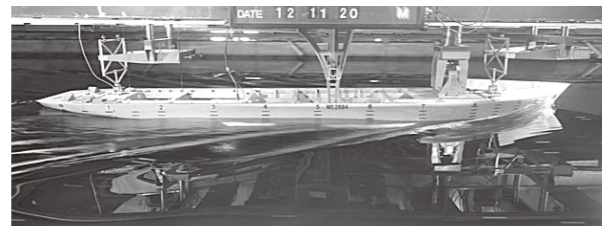
模型実験(平水面抵抗試験、株式会社三井造船昭島研究所)
